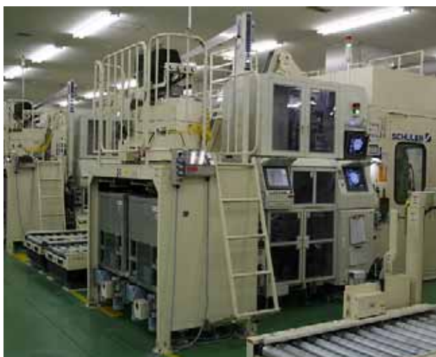
圧印機に直結した貨幣検査機
