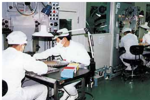
▲プルーフ貨幣製造設備、防塵室入口とその中での圧印作業(東京支局)▲
