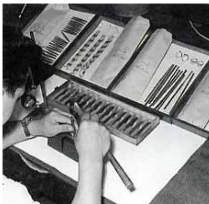
手打ちによる打刻作業(昭和30年代)
