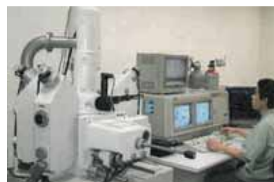
研究所の設備(X線マイクロアナライザーによる元素分析)
