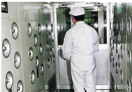
▲プルーフ貨幣製造設備、防塵室入口とその中での圧印作業(東京支局)▲
