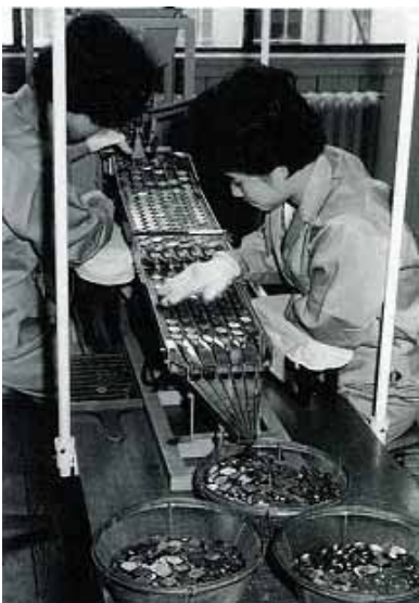
初期の振動方式検査機（昭和36年）
